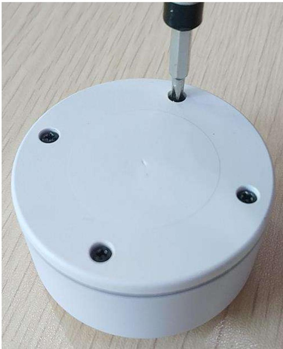
b.打开 VG05 的底部外壳，对准正负极，更换 2 节 ER14250 锂电池。
